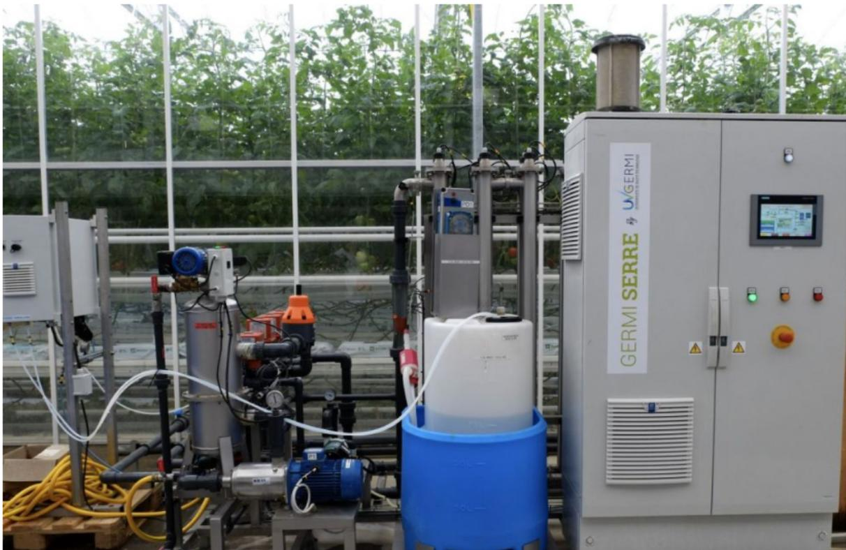
Réacteur UV d'UV Germi, installé dans la serre de tomates d'Auñtou.
